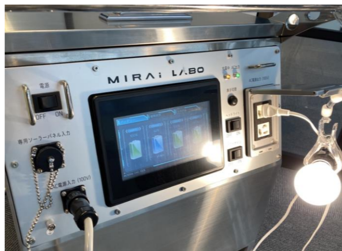
充電しながら、出力して電球を光らせている様子
