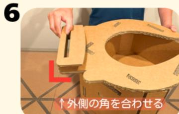
6 作成した土台部分の上に、パーツ(E)を配置する。
