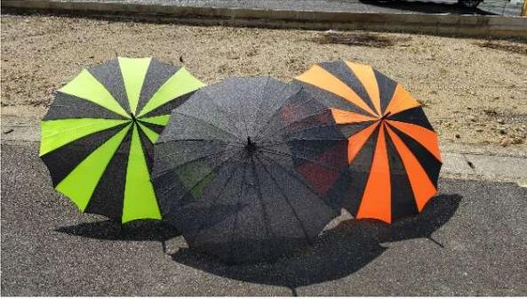
ジャンプ傘の生地部分をCYGUS生地に変更した防刃傘で、武器ではなく防具として開発されました。親骨と受骨はグラスファイバー製を使用。生地部分はCYGUS®なので切り付けではなかなか切れず、突き刺しでは状況によって穴が開きますが、そこから切り裂くのは難しいので、一定の距離を保ったり、凶器によっては奪う事も可能です。
